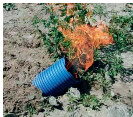
Рис. 5. Окрашенная в синий цвет гофрированная труба из обычного полиэтилена. Не имеет внутреннего НГ-слоя и уплотнителей. Решение предназначено для КЛ до 1 кВ
