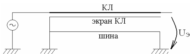
Рис. 5. Схема заземления экранов кабелей и шины
