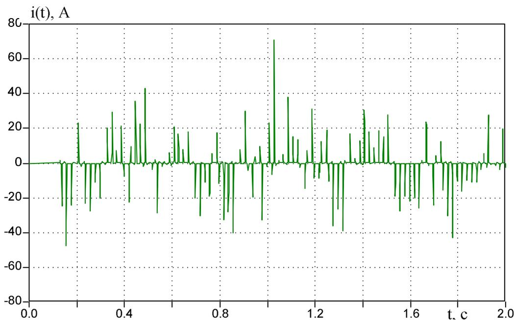
Рис.4.9. Ток ОПН 500 кВ фазы «В» при отключении в момент 0.1 с холостого блока АТ-ВЛ от сети 750 кВ двумя фазами «С» и «В» выключателя 750 кВ (треугольник АТ замкнут).
