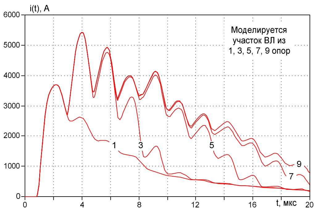
Рис.5.50. Влияние числа моделируемых опор ( R_s = 50 Ом у каждой) на ток в ОПН пораженной опоры (средняя из моделируемых опор). Удар молнии (40 кА, 2/200 мкс) в среднюю из моделируемых опор. На каждой опоре установлен ОПН только в фазе «В». Перекрытий изоляции нет.
