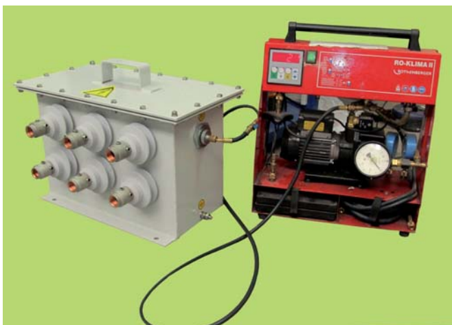
Рис. 3. Заводские испытания коробки на герметичность
