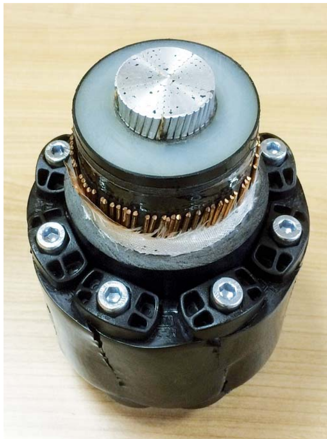
Рис. 2. Однофазный кабель с одетым на него кольцевым уплотнителем
